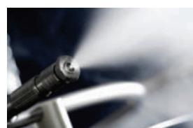
Система с форсунками высокого давления и каплезадерживающими пластинами
