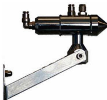
Подача воды обеспечивается за счёт эффекта эжекции, что создаёт полную безопасность при работе форсунок. Т.е. в случае неожиданного прекращения подачи сжатого воздуха вода не будет капать из форсунок. Этот тип форсунки имеет встроенную функцию очистки – специальная игла автоматически очищает внутренний канал от солей кальция, включаясь через регулярные интервалы времени.
