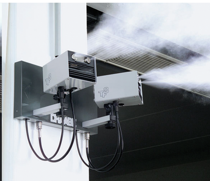
TF 8.2 и TF 16 Два атомайзера на одной панели производительностью 8 кг/ч и 16 кг/ч соответственно. Индивидуальная ориентация каждого атомайзера
